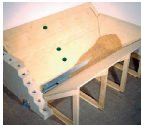
Abb. 25 Drucksensoren zur Füllstandsmessung im Schrägbodenlager
